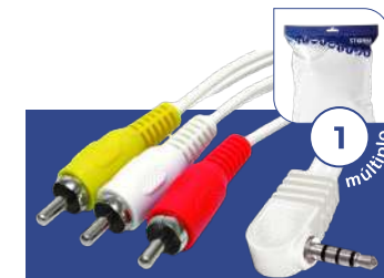
Cabo P2 4C 90° (vídeo, GND, áudio, áudio) branco x 3 RCA 1,8m, gold - aplicação: Ipod
